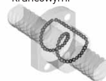
Rys. 3.3: Nakrętka z zewnętrznym mechanizmem przekierowania kulek z ostonkami krańcowymi
