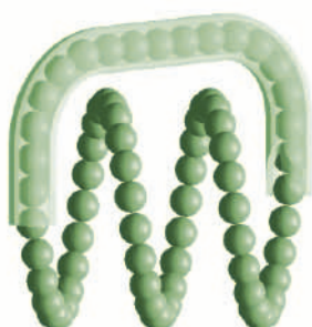
Rys. 3.4: Obieg kulek przy zewnętrznym mechanizmie przekierowania kulek
